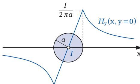
Abbildung 5.11: Magnetische Feldstärke auf der  $x$ -Achse
