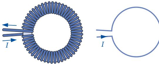
Abbildung 5.14: Einlagige Toroidspule
