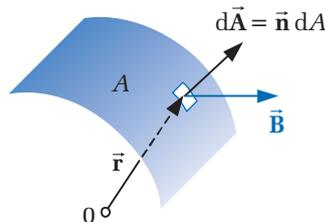
Abbildung 5.18: Magnetischer Fluss  $\Phi$  durch die Fläche  $A$
