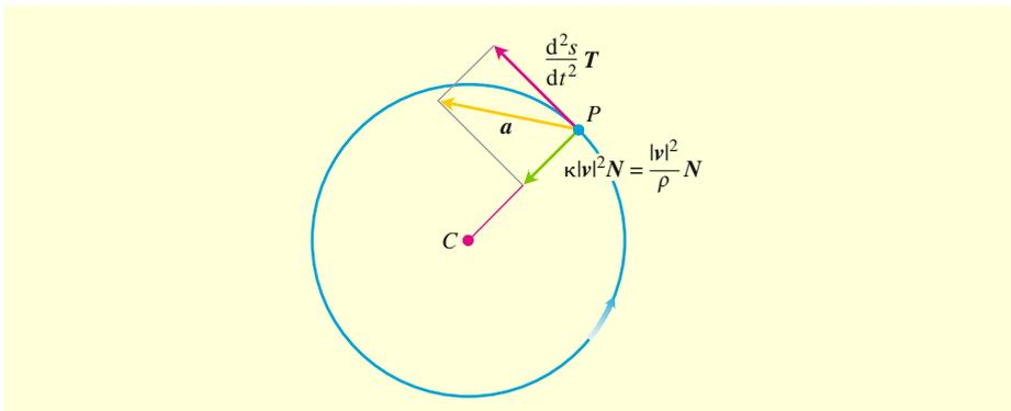
**Abbildung 13.26** Die Tangentialkomponente und die Normalkomponente der Beschleunigung eines Teilchens, das sich entgegen dem Uhrzeigersinn entlang einer Kreisbahn mit Radius  $\rho$  bewegt und dabei schneller wird.
