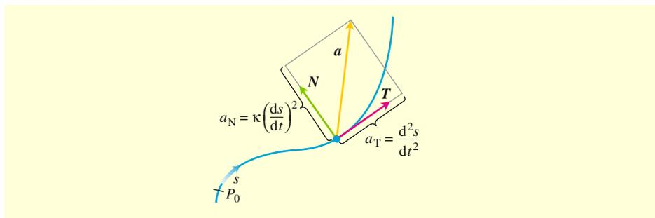
**Abbildung 13.25** Die Tangential- und die Normalkomponente der Beschleunigung. Der Beschleunigungsvektor  $a$  liegt in der Ebene von  $T$  und  $N$ , senkrecht zu  $B$ .
