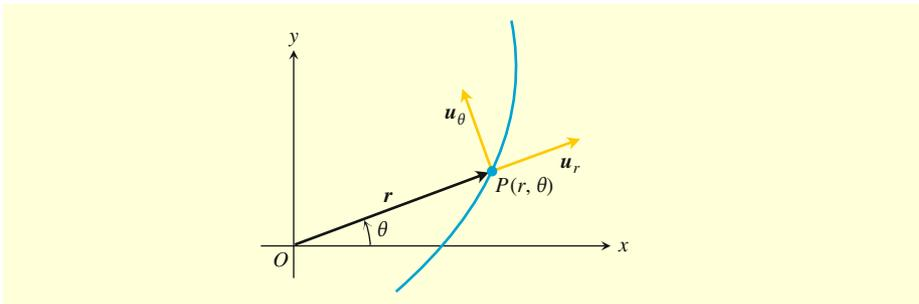
**Abbildung 13.30** Die Länge von  $r$  entspricht der positiven Polarkoordinate  $r$  des Punkts  $P$ .  $\mathbf{u}_r$  ist gleich  $\mathbf{r}/|r|$  und damit gleich  $\mathbf{r}/r$ . In Gleichung (13.26) werden  $\mathbf{u}_r$  und  $\mathbf{u}_\theta$  mit den Vektoren  $\mathbf{i}$  und  $\mathbf{j}$  geschrieben.
