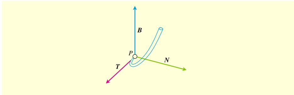
**Abbildung 13.24** Die Vektoren  $T$ ,  $N$  und  $B$  bilden – in dieser Reihenfolge – ein rechtshändiges System aus drei aufeinander senkrecht stehenden Vektoren im Raum.
