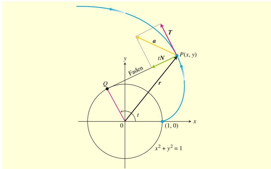
**Abbildung 13.27** Die Tangential- und Normalkomponente der Beschleunigung von  $r(t) = (\cos t + t \sin t)\mathbf{i} + (\sin t - t \cos t)\mathbf{j}$  für  $t > 0$ . Wird ein Faden, der um einen Kreis gewickelt ist, abgewickelt und dabei gespannt in der Ebene des Kreises gehalten, so beschreibt sein Ende  $P$  eine Evolvente (Abwicklungskurve) des Kreises.
