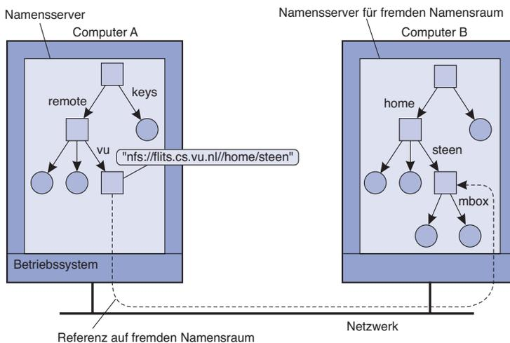
Abbildung 5.12: Mounting entfernter Namensräume durch ein besonderes Zugriffsprotokoll
