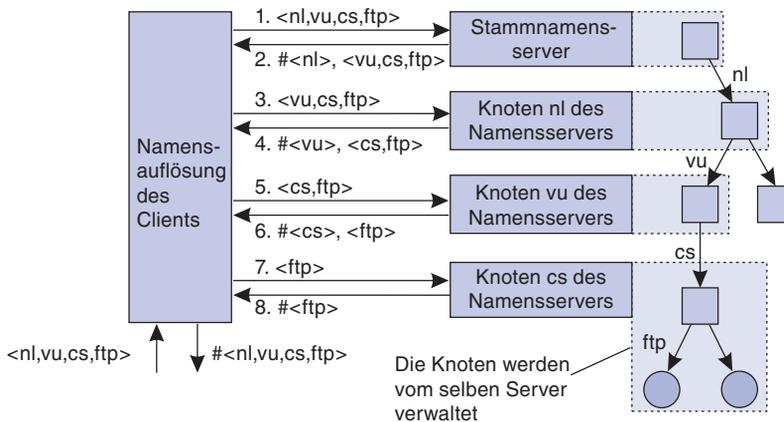
Abbildung 5.15: Das Prinzip der iterativen Namensauflösung
