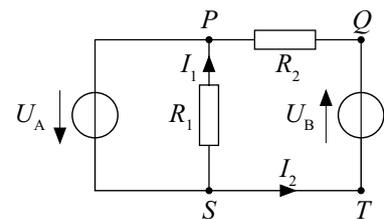
a. Stellen Sie eine algebraische Gleichung auf, welche die Potentiale  $\Phi_P$  und  $\Phi_S$  an den Punkten  $P$  und  $S$  miteinander in Beziehung setzt.
