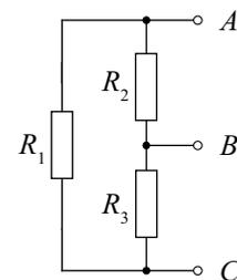
Hängt die Zerlegung in Reihen- und Parallelschaltungen von den Anschlüssen der Quelle ab?
