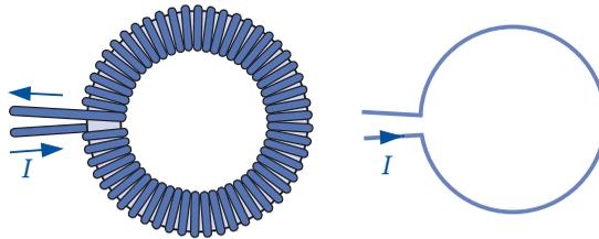
Abbildung 5.14: Einlagige Toroidspule
