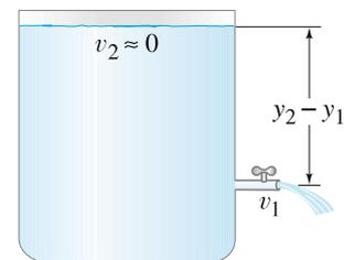
**Abbildung 13.25** Das Gesetz von Torricelli:  $v_1 = \sqrt{2g(y_2 - y_1)}$ .
