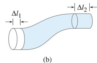
Abbildung 13.24 Fluidfluss: Herleitung der Bernoulli'schen Gleichung.
